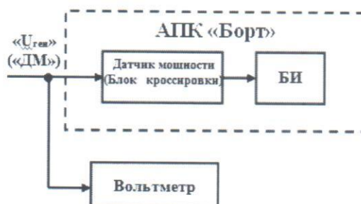
Рисунок Б.2 – Структурная схема подключения при поверке ИК измерения напряжения постоянного тока на зажимах тягового генератора
