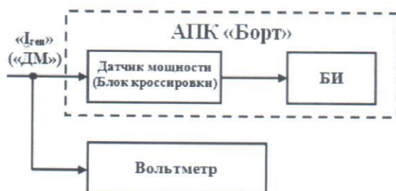
Рисунок Б.1 – Структурная схема подключения при поверке ИК измерения силы постоянного тока тягового генератора
