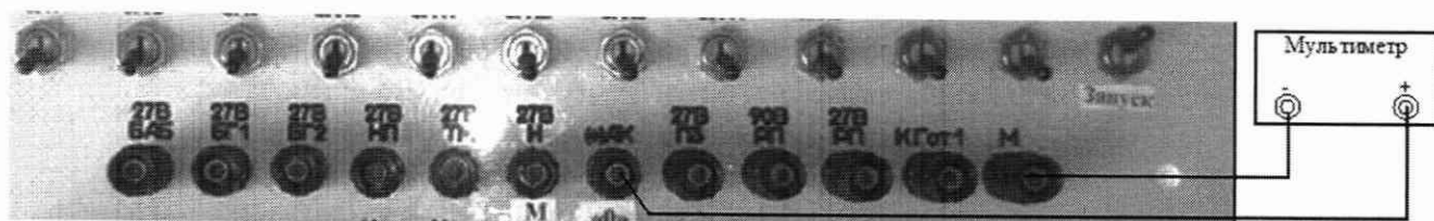
Рисунок 69 - Схема подключения мультиметра по цепи «(+) АК»
