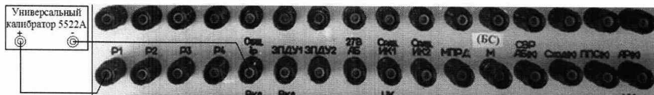
Рисунок 122 - Схема подключения калибратора по цепи «P1»
