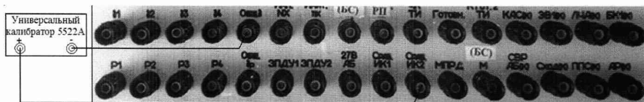
Рисунок 108 - Схема подключения калибратора по цепи «Сраб ИК2»
