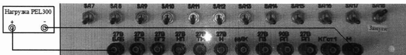
Рисунок 20 - Схема проверки цепей измерений токов
