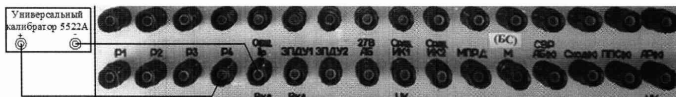
Рисунок 128 - Схема подключения калибратора по цепи «P4»
