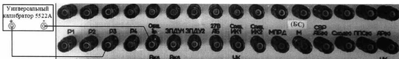
Рисунок 126 - Схема подключения калибратора по цепи «P3»
