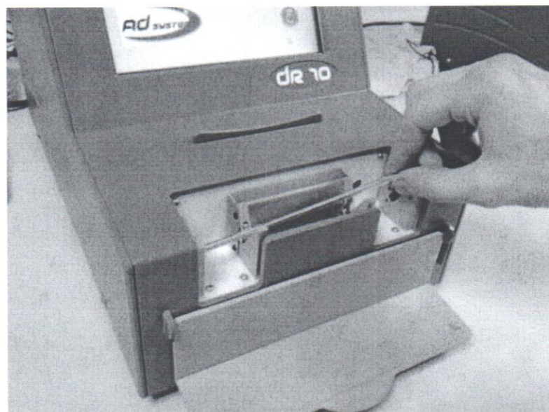
Рисунок 2 - Установка меры на опоры в тестовом отделении
