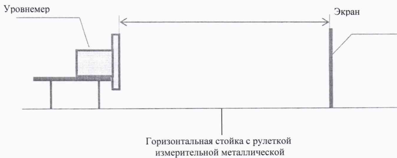
Р и с у н о к А . 1 - Установка уровня при поверке
