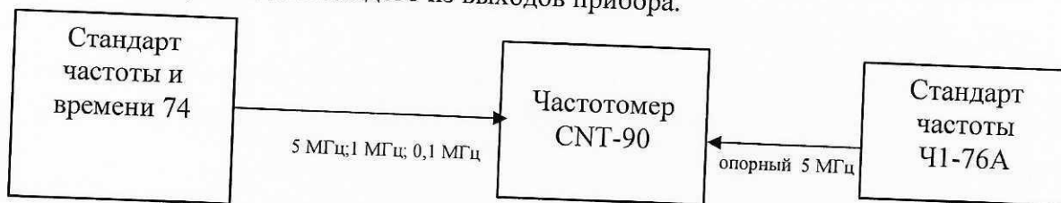
Рисунок 2 - Определение значений частот выходных синусоидальных сигналов 5 МГц, 1 МГц, 0,1 МГц
