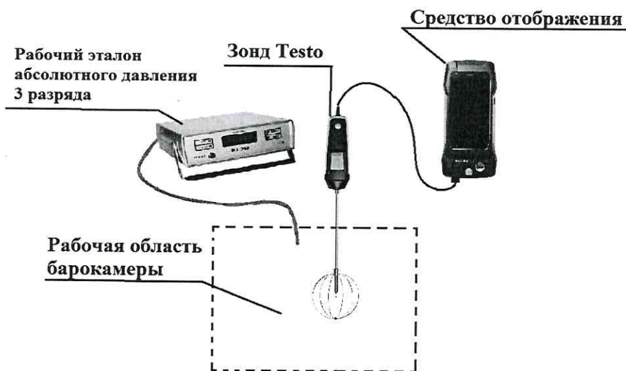
Рисунок 6 – Схема определения абсолютной погрешности измерений абсолютного давления
