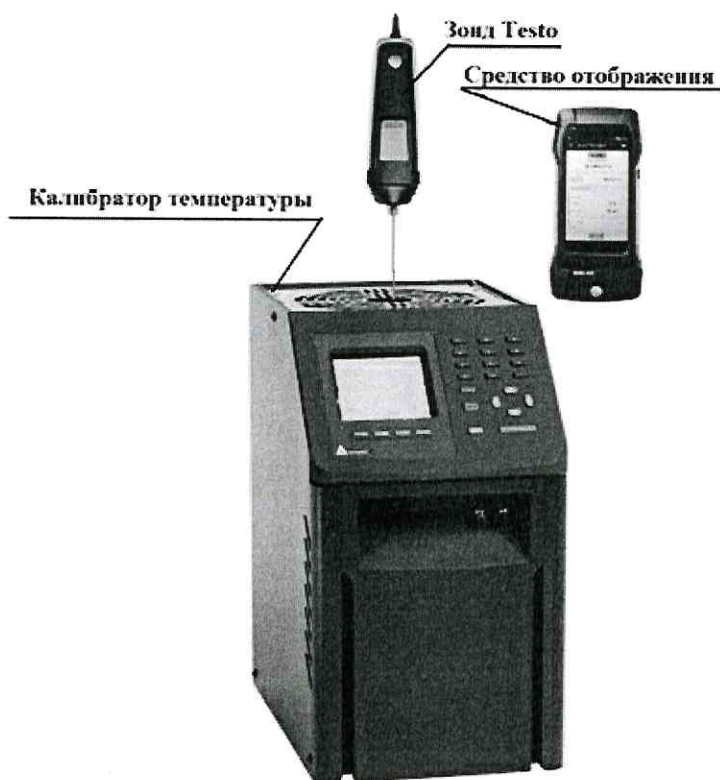
Рисунок 2 – Схема определения абсолютной погрешности измерений температуры методом прямых измерений
