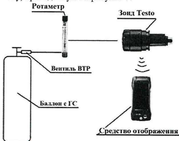
Рисунок 7 – Схема подачи газовых смесей
