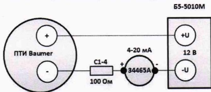
8.4 Подать напряжение питания 12 В на ПТИ и считать с помощью мультиметра значение силы тока выходного сигнала. По измеренному значению силы тока рассчитать значение измеренной температуры окружающего воздуха по формуле
