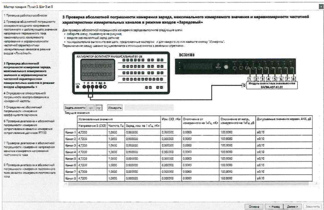
Рисунок 12 – Измерения АЧХ Зарядового канала
