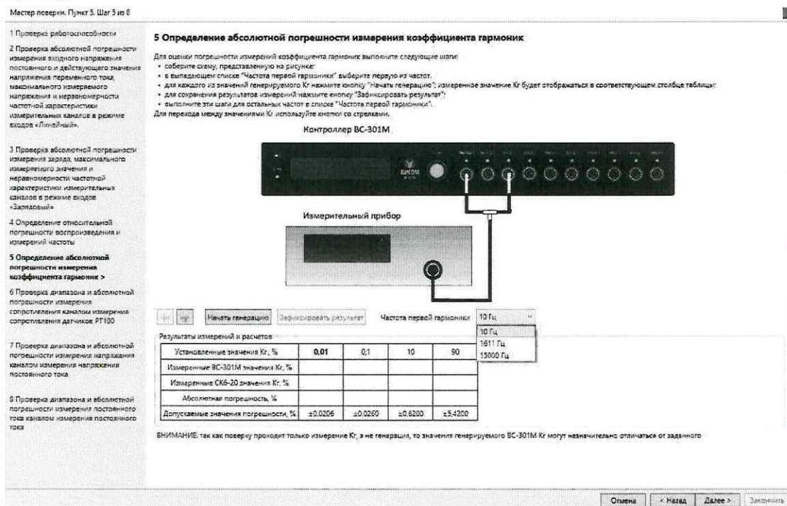
Рисунок 15 – Схема проверки погрешности измерений коэффициента гармоник
