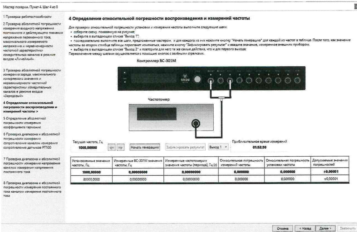
Рисунок 13 – Схема проверки относительной погрешности измерений и воспроизведения частоты
