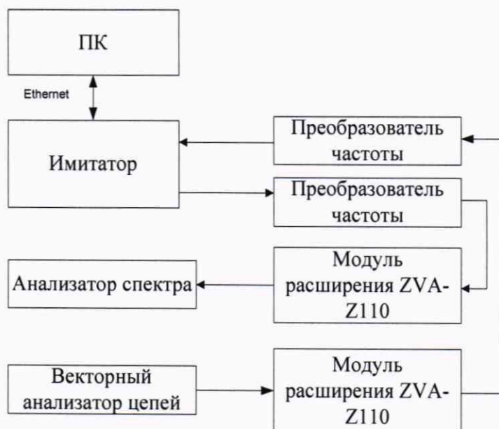
Рисунок 1 – Схема подключения имитатора при определении относительной погрешности частоты имитации
