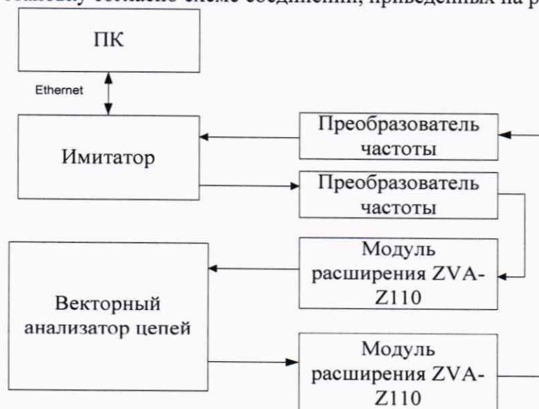
Рисунок 2 – Схема подключения имитатора при определении диапазона воспроизведения дальности до цели
