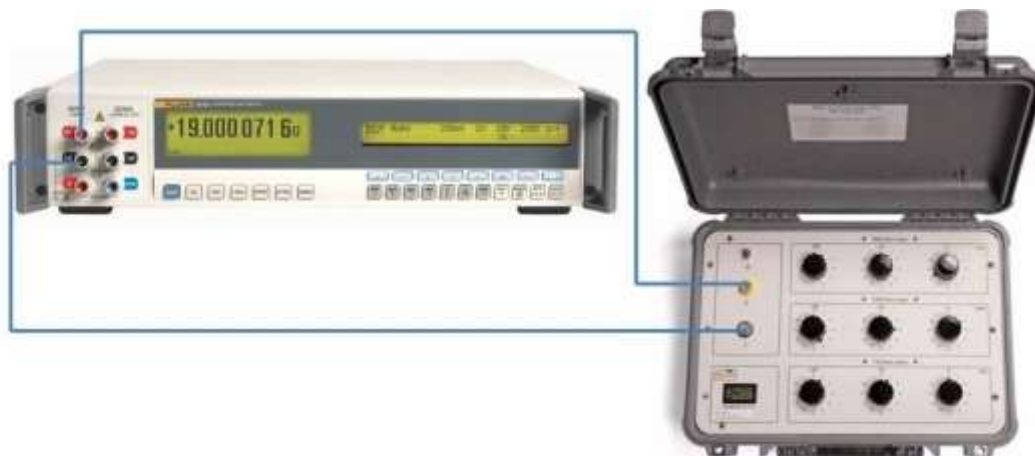
Рисунок 1 – Схема соединения меры АКИП-7516 и мультиметра 8508А при определении воспроизведения сопротивления постоянному току
