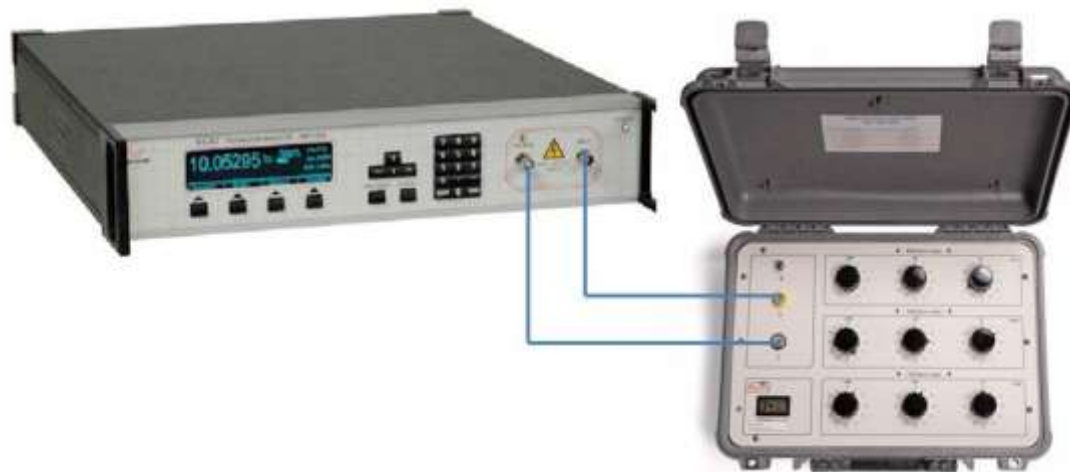
Рисунок 2 – Схема соединения меры АКИП-7516 и тераомметра 6530 при определении воспроизведения сопротивления постоянному току
