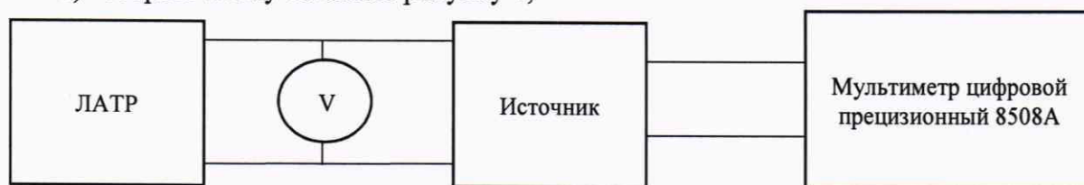
Рисунок 4 - Схема подключения при определении нестабильности выходного напряжения и нестабильности силы выходного тока, вызванных изменением напряжения в сети питания
