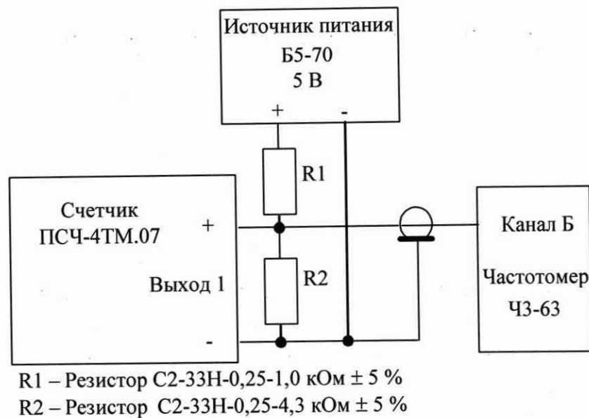
Рисунок 13 – Схема подключения оборудования для проверки точности хода часов
