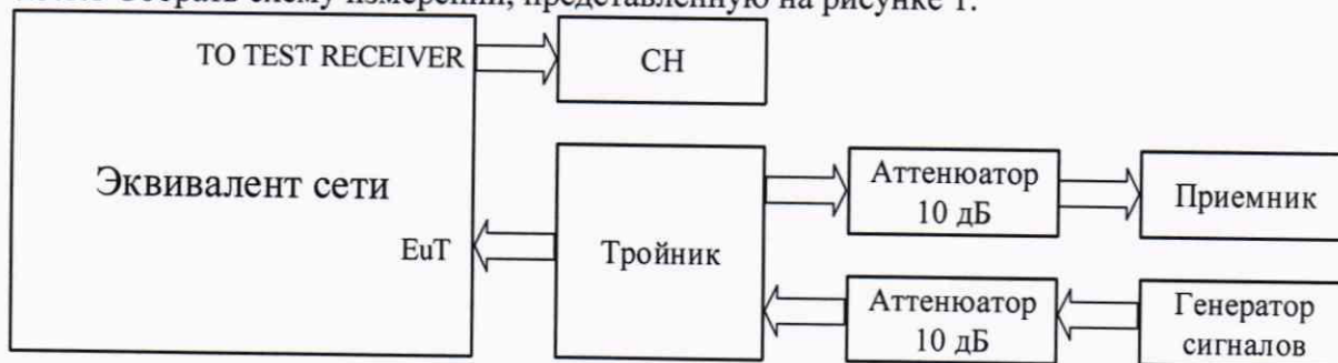
Рисунок 1 - Схема калибровки выходного уровня генератора сигналов
