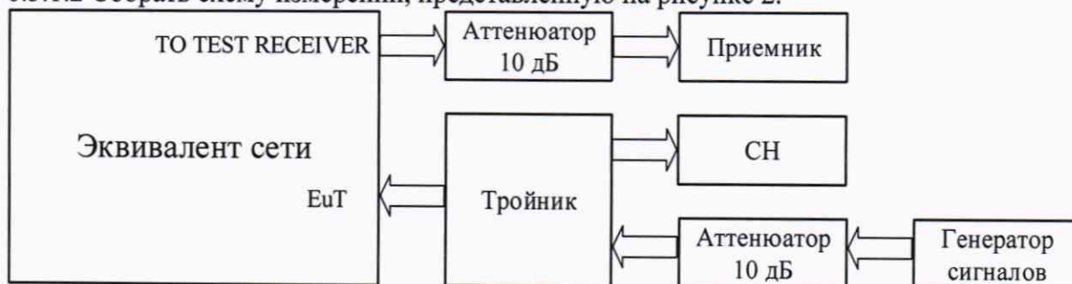
Рисунок 2 - Схема измерений выходного уровня эквивалента сети
