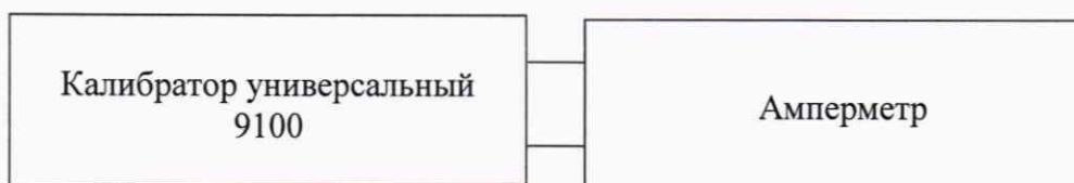
Рисунок 1 – Схема подключения для определения приведенной (к верхнему пределу диапазона измерений) погрешности измерений модификаций S5I□□□-□
