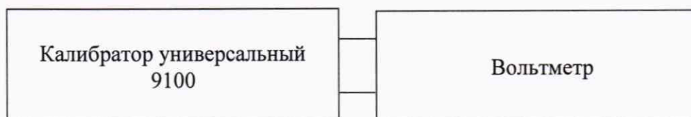
Рисунок 1 – Схема подключения для определения приведенной (к верхнему пределу диапазона измерений) погрешности измерений модификаций S5U□□□-□
