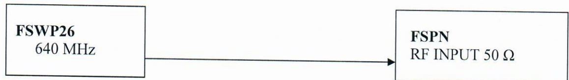
Рисунок 4 – Структурная схема соединения СИ для определения уровня собственных фазовых шумов
