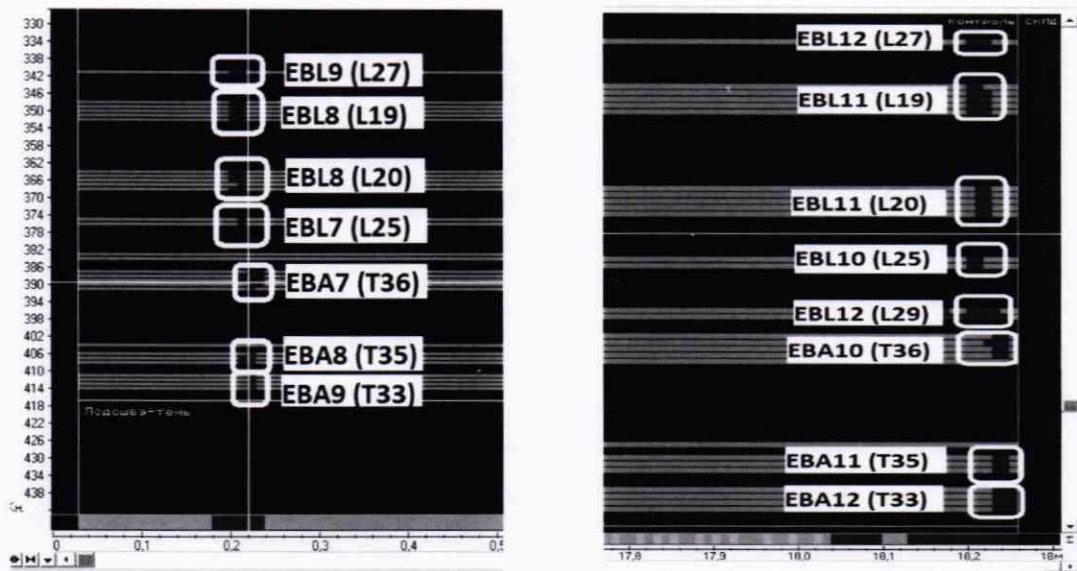
Рисунок 4 – Модели дефектов на переднем (слева) и заднем (справа) конце СО5 для датчиков L19, L20, L25, L27, L29 и T33, T35, T36
