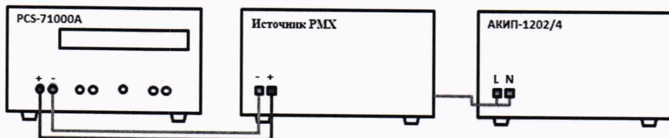
Рисунок 2 – Схема соединения приборов для определения погрешности установки/измерений силы постоянного тока
