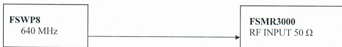
Рисунок 15 – Структурная схема соединения СИ для определения уровня собственных фазовых шумов
