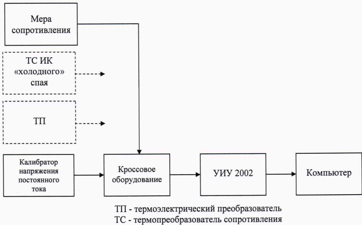
а) Схема определения метрологических характеристик с использованием калибратора напряжения постоянного тока, не имеющего режима компенсации температуры «холодных спаев»
