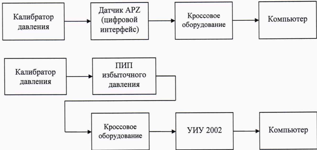
а) Схема определения метрологических характеристик комплектным способом
