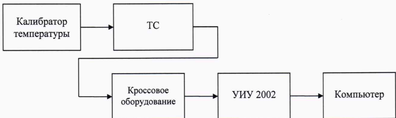
а) Схема определения метрологических характеристик комплектным способом
