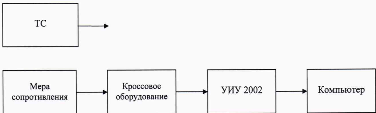
б) Схема определения метрологических характеристик поэлементным способом
