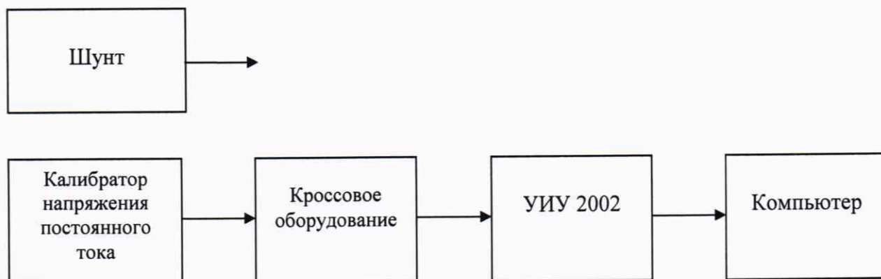
Рисунок Б.10 - Схема определения метрологических характеристик ИК силы постоянного тока (с шунтами)
