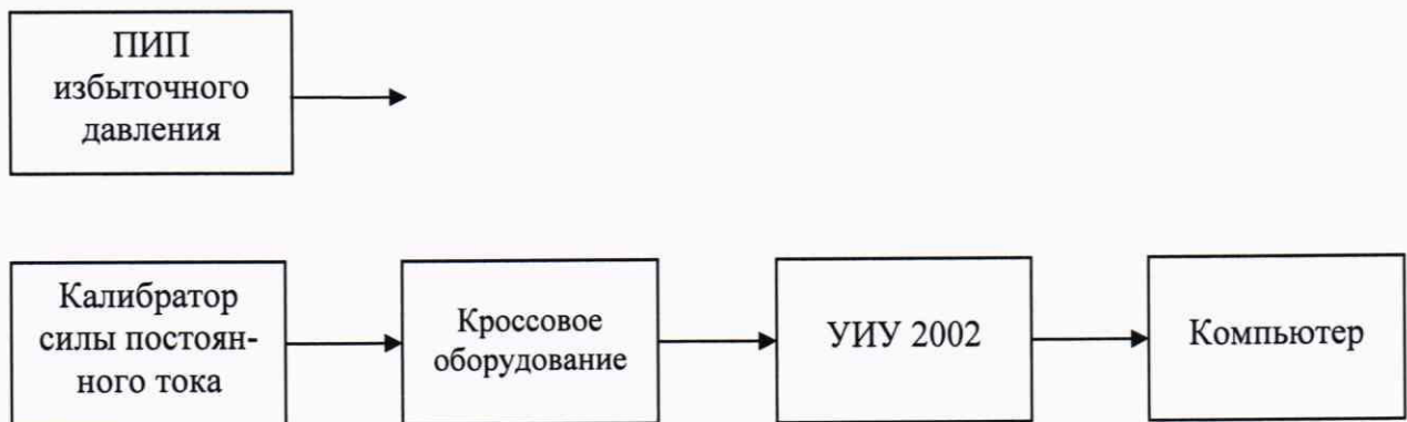
б) Схема определения метрологических характеристик поэлементным способом
