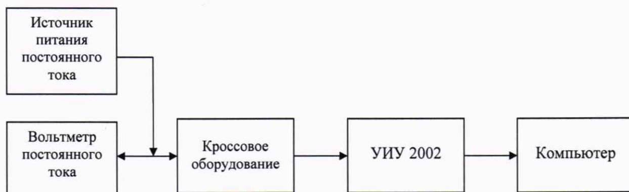
Рисунок Б.8 - Схема определения метрологических характеристик ИК виброскорости
