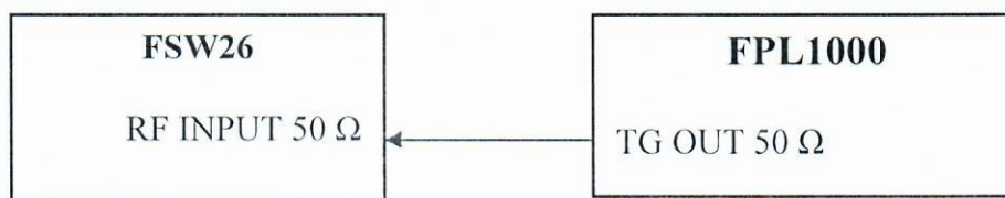
Рисунок 11 – Структурная схема соединения СИ для определения уровня фазовых шумов на частоте 1 ГГц
