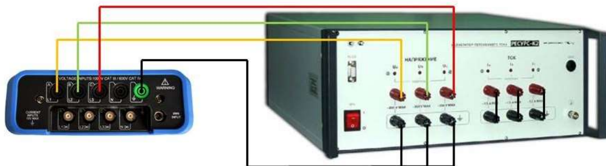
Рисунок 4 – Схема подключения приборов при определении погрешности измерения коэффициента n-ой гармонической составляющей напряжения, угла фазового сдвига между гармоническими составляющими напряжения
