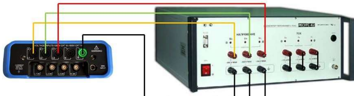
Рисунок 6 – Схема подключения приборов при определении погрешности измерения значений и длительности провалов и выбросов напряжения, коэффициента несимметрии напряжений, угла фазового сдвига между напряжениями основной частоты
