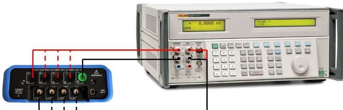
Рисунок 3 – Схема подключения приборов при определении погрешности измерения мощности и коэффициента мощности
