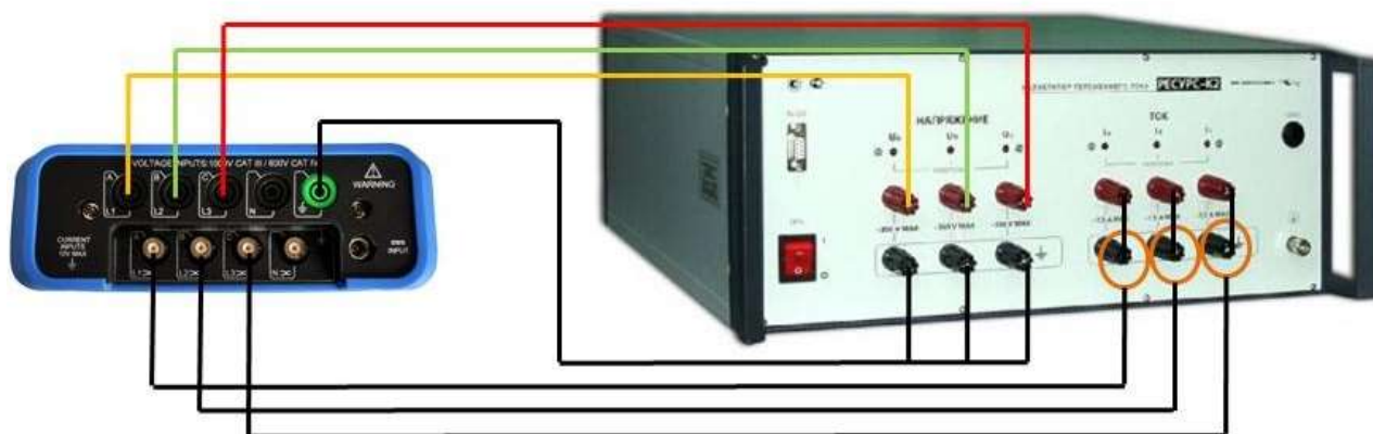
Рисунок 5 – Схема подключения приборов при определении погрешности измерения коэффициента n-ой гармонической составляющей тока, угла фазового сдвига между гармоническими составляющими тока
