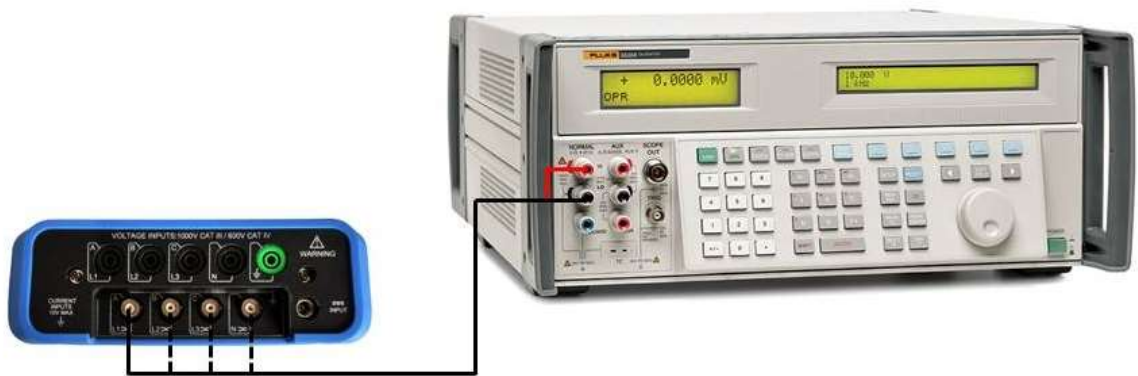
Рисунок 2 – Схема подключения приборов при определении погрешности измерения силы переменного тока без использования токовых преобразователей.
