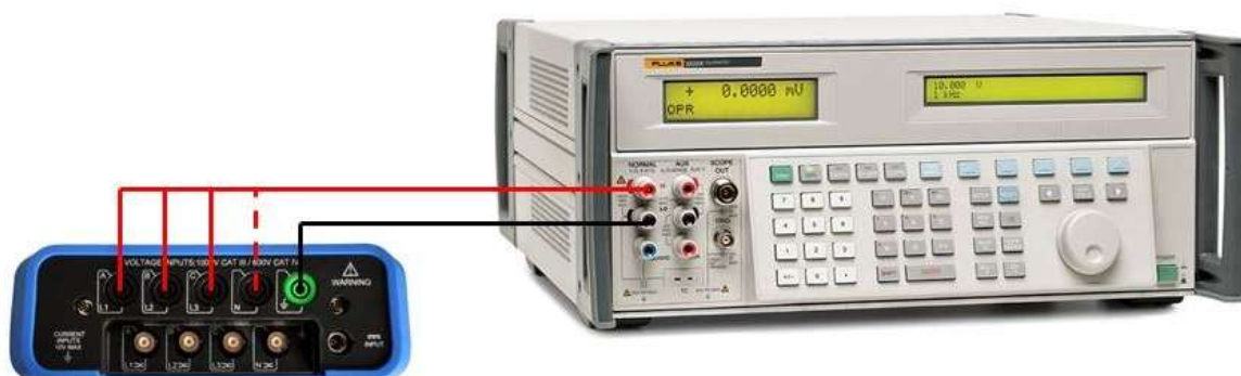
Рисунок 1 – Схема подключения приборов при определении погрешности измерения напряжения, частоты, дозы фликера
