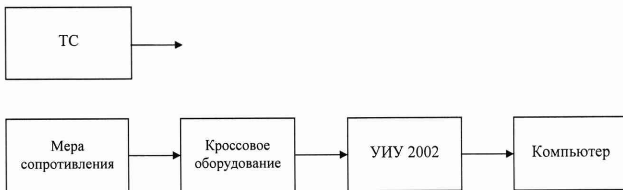
б) Схема определения метрологических характеристик поэлементным способом
