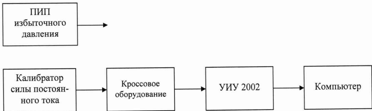
б) Схема определения метрологических характеристик поэлементным способом
