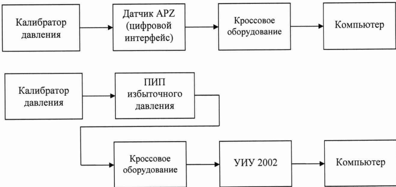
а) Схема определения метрологических характеристик комплектным способом
