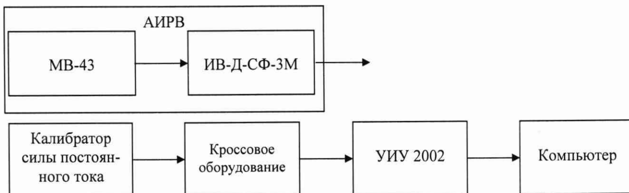
Рисунок 9 - Схема определения метрологических характеристик ИК виброскорости
