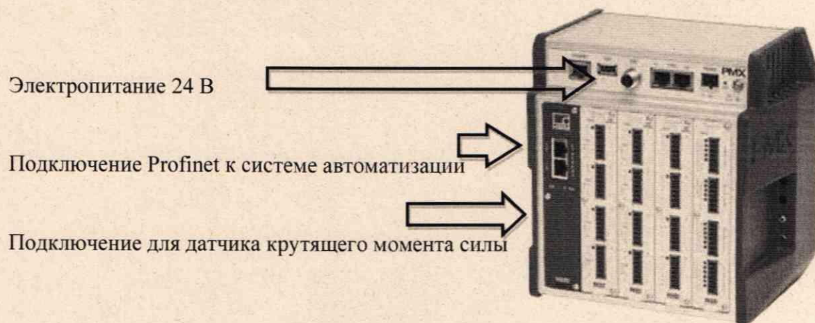
Рисунок 13 - Подключение измерительного усилителя после установки
