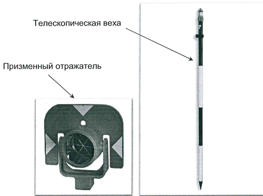
Рисунок А.1 – Веха телескопическая с призмным отражателем
