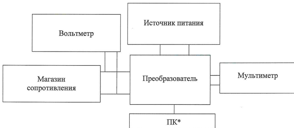
Рисунок 2 – Схема подключений для определения основной погрешности преобразователей модификаций 9180, 9182, 9282 (исполнение 9282/11-51-16)
