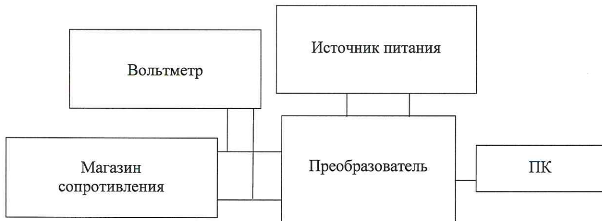
Рисунок 6 – Схема подключений для определения основной погрешности преобразователей модификации 9482
