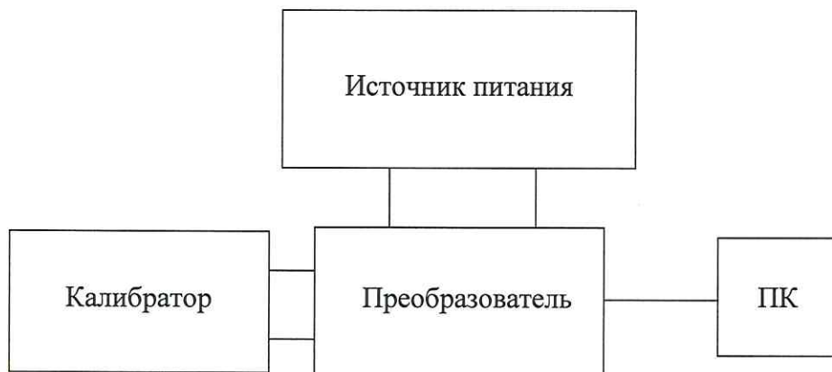
Рисунок 4 – Схема подключений для определения основной погрешности измерений преобразователей модификаций 9468, 9469
