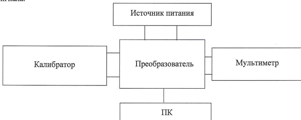
Рисунок 3 – Схема подключений для определения основной погрешности преобразователей модификаций 9182, 9282 (исполнение 9282/12-51-16), 9468, 9469
