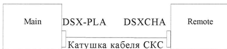
Рисунок 2 – Схема соединения анализатора при определении абсолютной погрешности измерений длины кабеля
