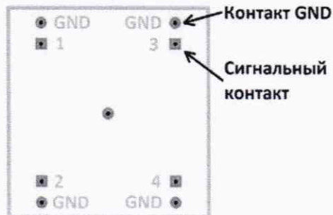
Рисунок 13 – Контакты для калибровки устройства ТСКЯ.418133.416
