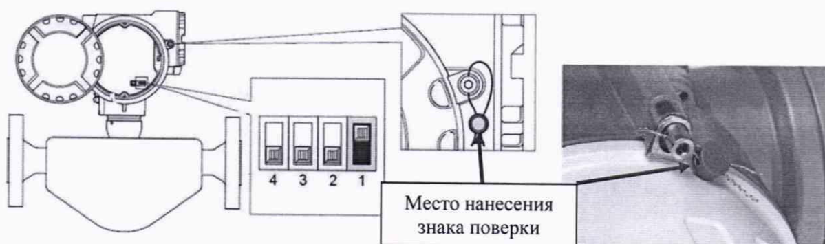
Р и с у н о к Б . 2 – Схема пломбировки расходомера массового LPGmass
