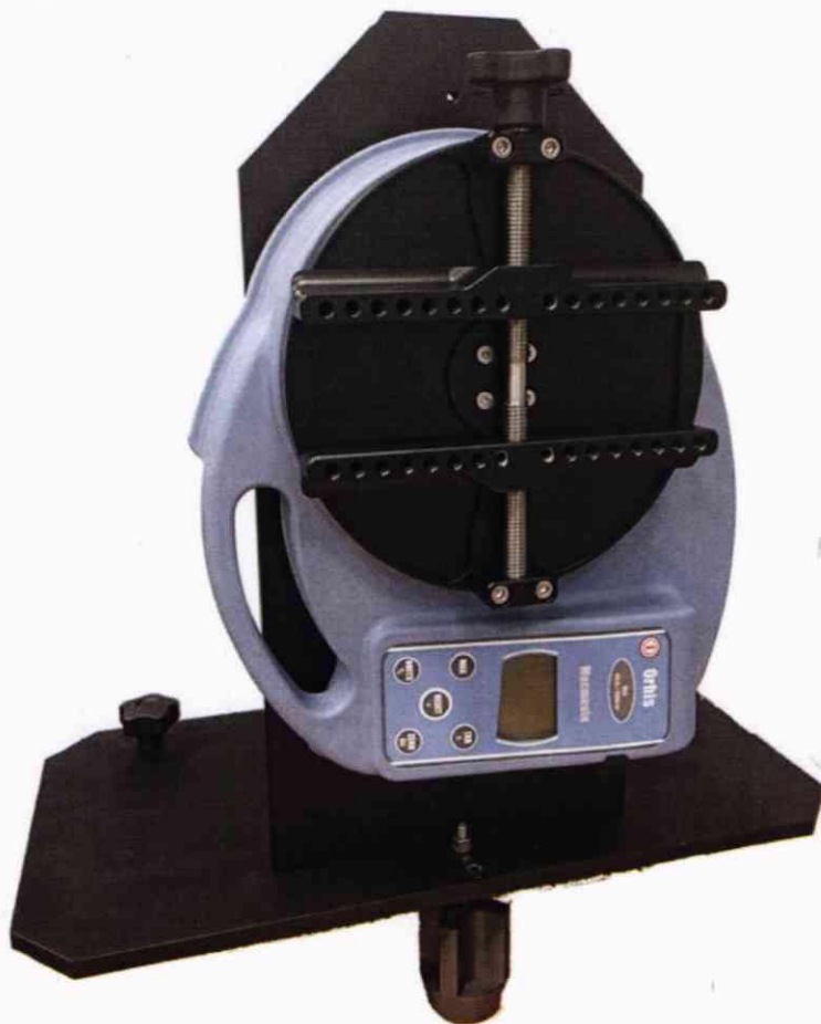
Рисунок 1 – Схема крепления измерителей Orbita, Tornado, VTG Tornado
