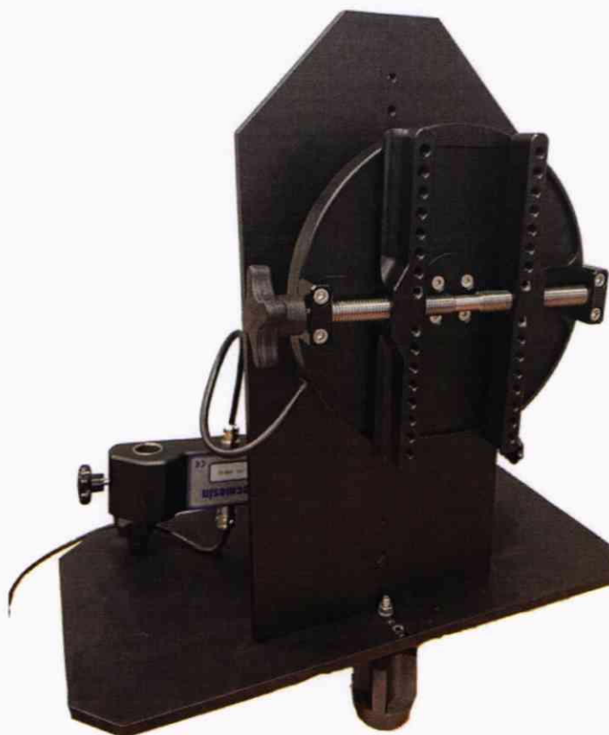
Рисунок 2 – Схема крепления измерителей Vortex, Helixa
