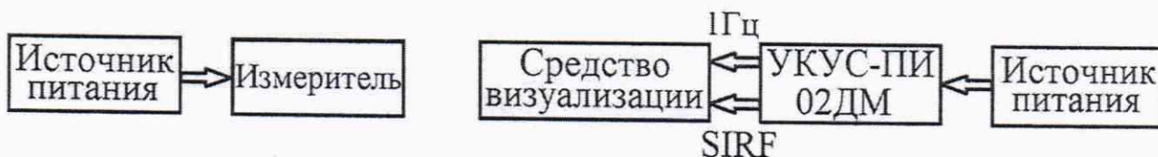
Рисунок 1 – Схема по определению абсолютной погрешности синхронизации времени
