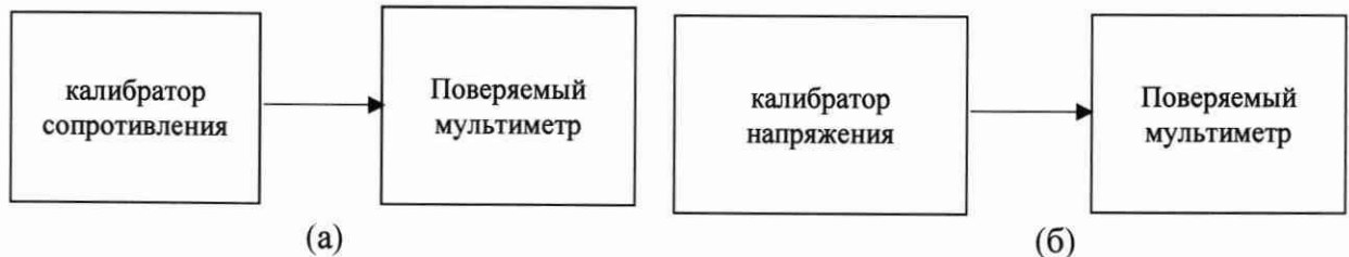
Рисунок 7 - Схема соединения приборов при поверке мультиметра в режиме измерений температуры: а) в режиме измерений сигналов термопреобразователей сопротивления, б) в режиме измерений сигналов термоэлектрических преобразователей
