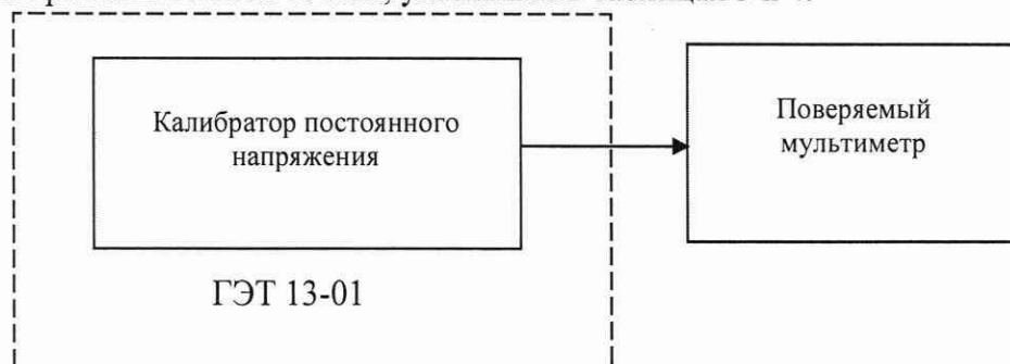
Рисунок 2 - Схема соединения приборов при определении основной погрешности мультиметра в режиме измерений постоянного электрического напряжения
