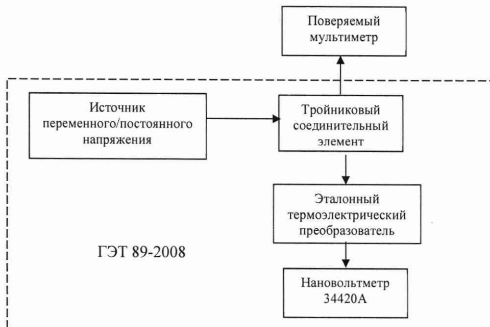
Рисунок 4 - Схема соединения приборов при поверке мультиметра в режиме измерений переменного электрического напряжения
