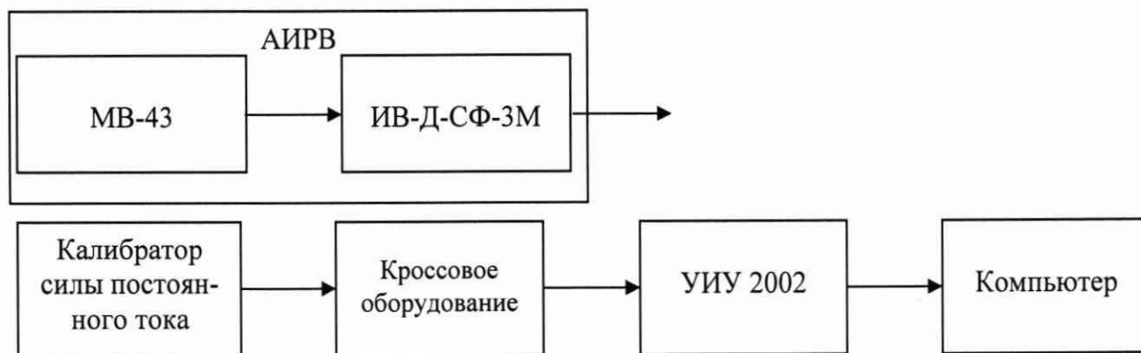
Рисунок 9 - Схема определения метрологических характеристик ИК виброскорости
