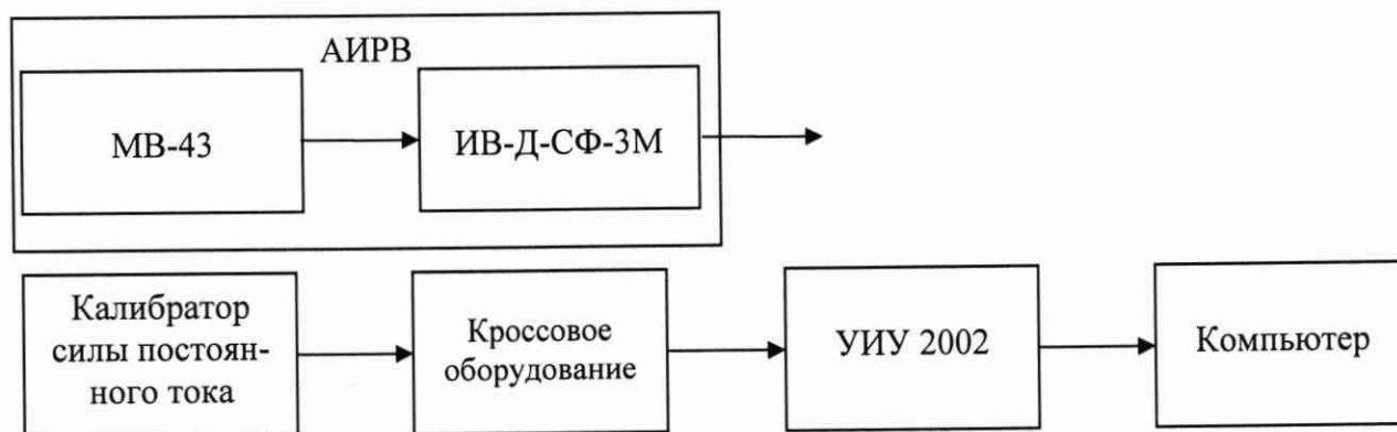
Рисунок 11 - Схема определения метрологических характеристик ИК виброускорения
