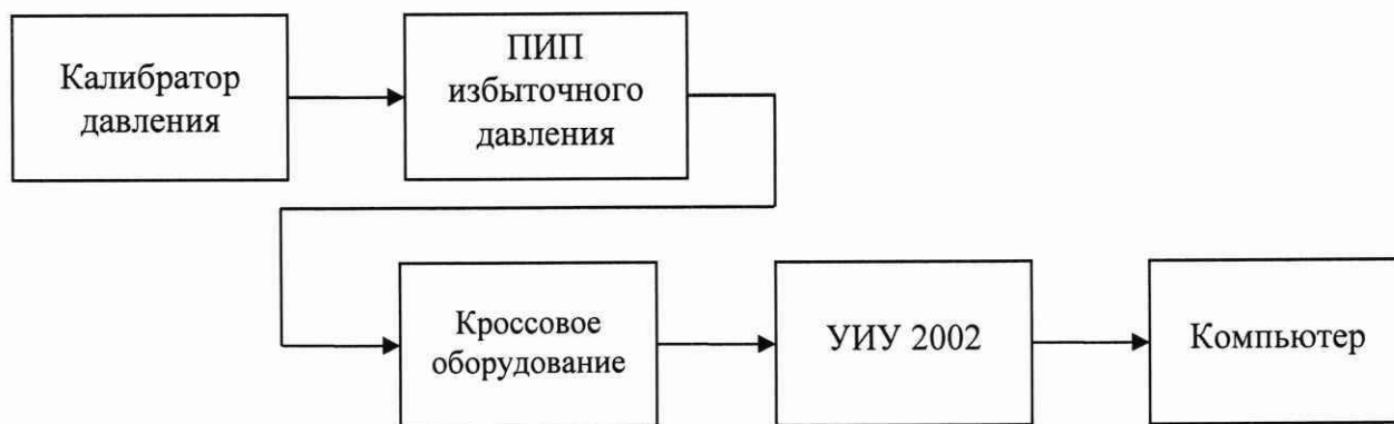
а) Схема определения метрологических характеристик комплектным способом
