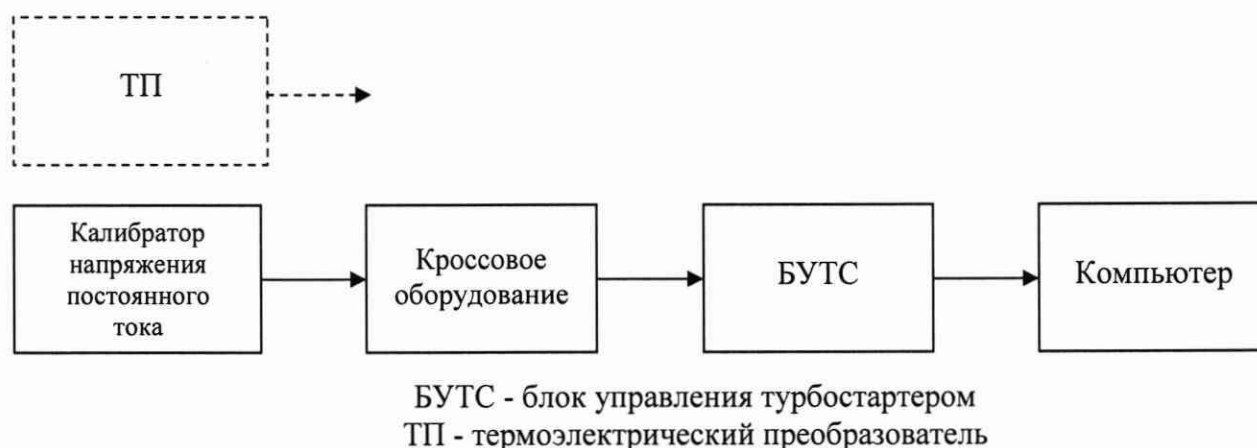
Рисунок 6 - Схема определения метрологических характеристик ИК напряжения постоянного тока, соответствующего значениям температуры, измеряемой термоэлектрическими преобразователями ХА по ГОСТ Р 8.585-2001
