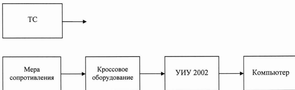
б) Схема определения метрологических характеристик поэлементным способом
