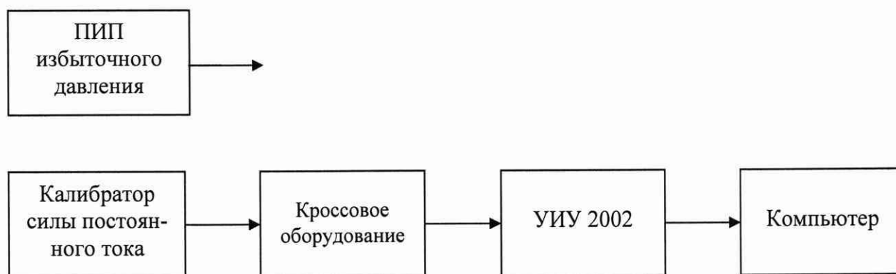
б) Схема определения метрологических характеристик поэлементным способом
