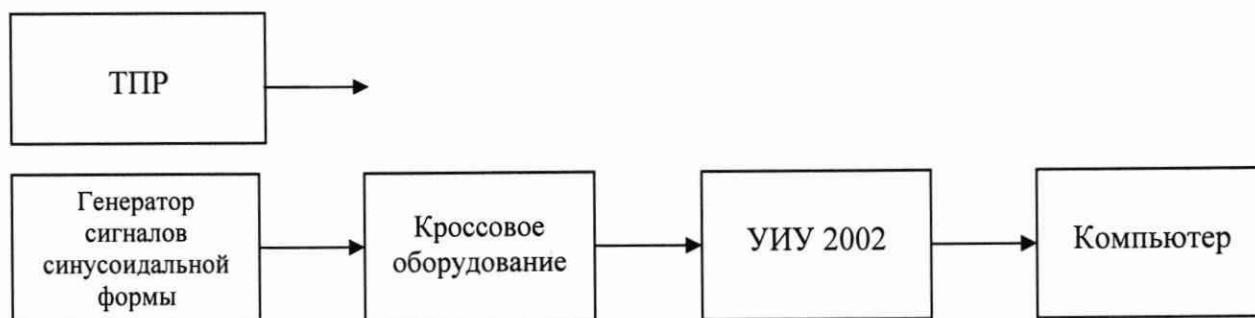
Рисунок 16 - Схема определения метрологических характеристик ИК объемного расхода жидкости
