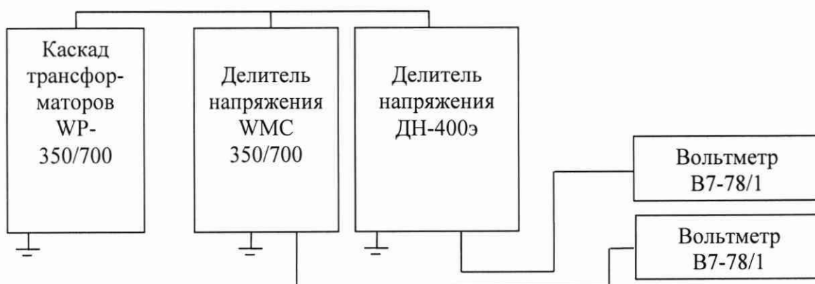
Рисунок 1 - Схема измерений напряжения переменного тока до 400 кВ
