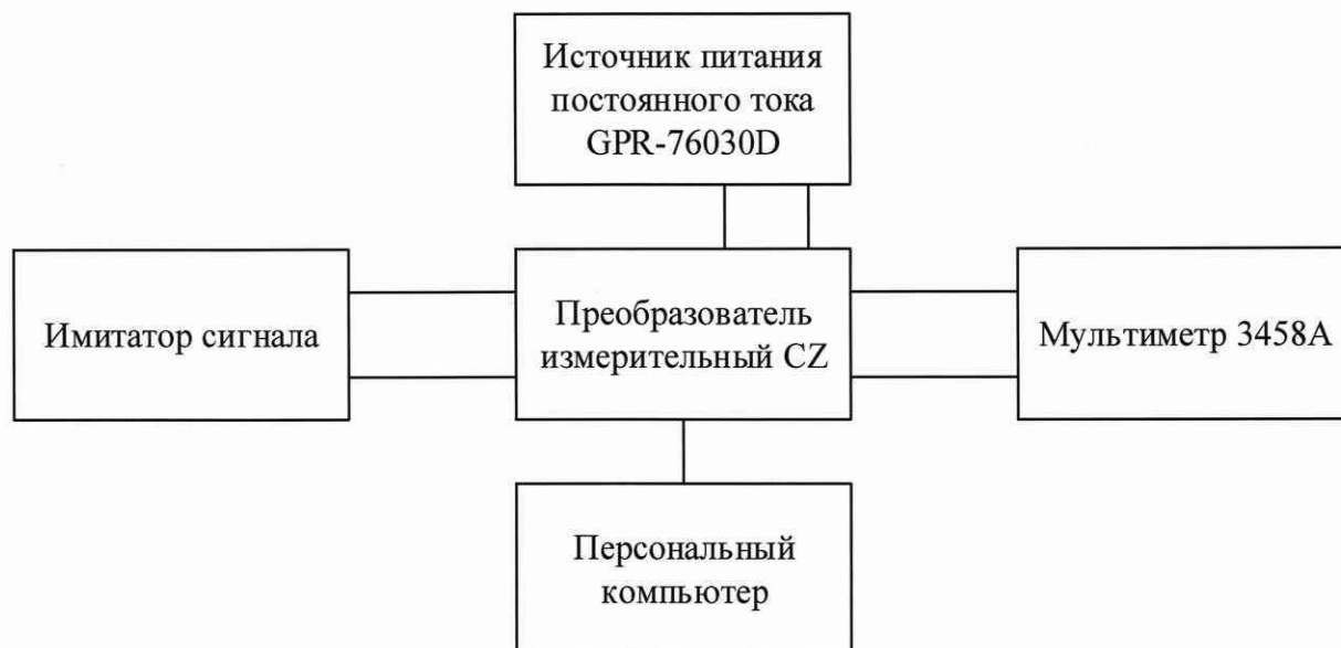
Рисунок А.1 – Схема определения основной приведенной (к верхнему пределу диапазона входного сигнала) погрешности преобразований Имитатор сигналов - Калибратор многофункциональный и коммуникатор ВЕАМЕХ МС6 (-R), Мера электрического сопротивления постоянного тока многозначная МС3070М-1, Генератор сигналов специальной формы АКИП-3409/1
