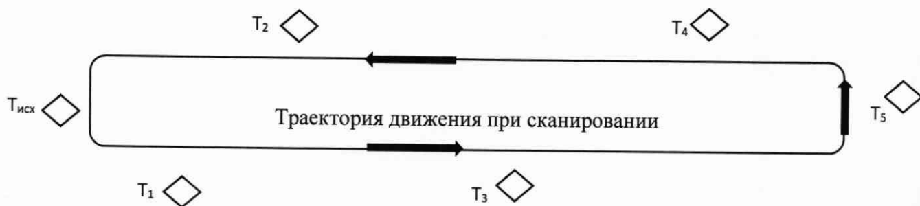
Рисунок 1 - Схема расположения марок в контрольных точках сканирования и пример траектории сканирования
