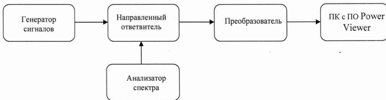
Рисунок 4 – Схема определения погрешности измерений мощности, модулированных сигналов
