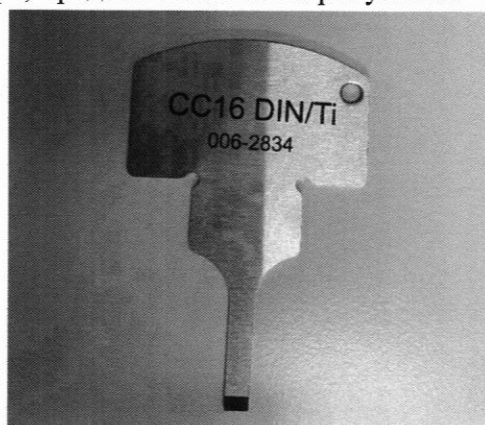
Рисунок 1 – Приспособление для определения уровня ГСО в стакане реометра
