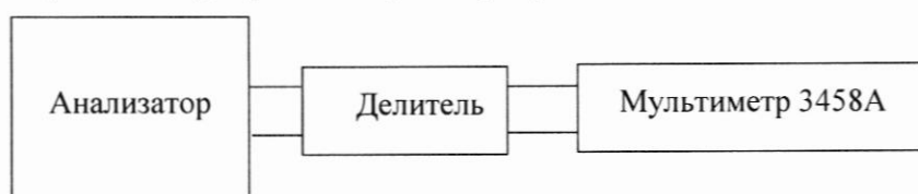
Рисунок 3 – Структурная схема определения абсолютной погрешности воспроизведений/измерений напряжения постоянного тока (св. 1000 В)
