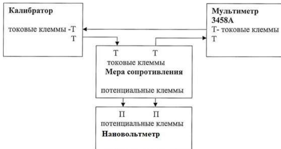
Рисунок 1 – схема соединения приборов при определении погрешности измерения силы постоянного тока
