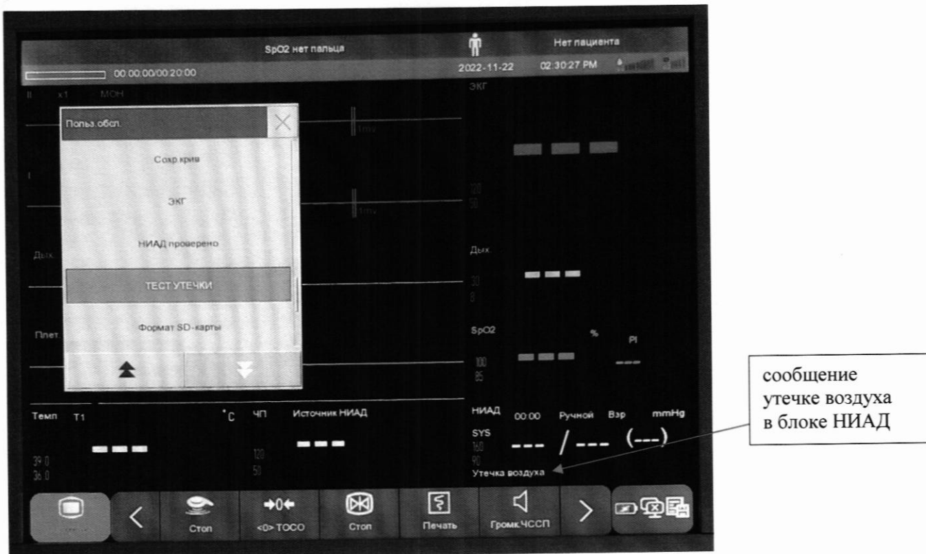
Рисунок 4 – сигнал утечки пневмосистемы монитора.
