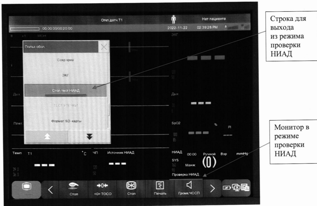
Рисунок 6 – монитор в режиме проверки НИАД.
