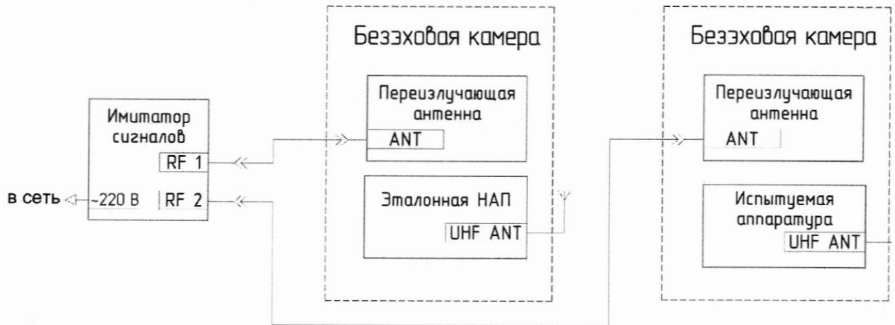
Рисунок 1 — схема подключения аппаратуры для определения доверительных границ абсолютной погрешности измерений координат в дифференциальном кодовом режиме
