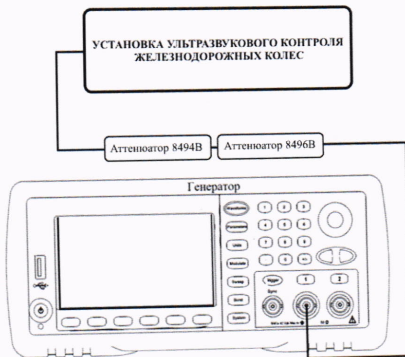
Рисунок 6 – Схема подключения при определении диапазона и абсолютной погрешности измерений отношения амплитуд сигналов на входе приёмника установки
