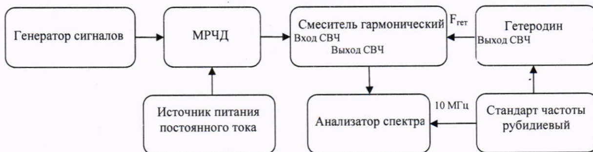
Рисунок 1 – Схема определения относительной погрешности установки частоты выходного сигнала
