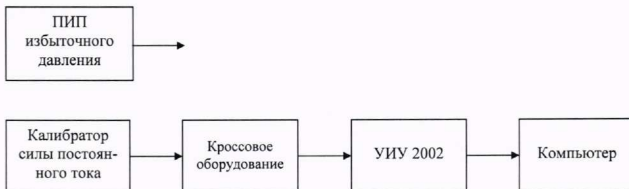
б) Схема определения метрологических характеристик поэлементным способом
