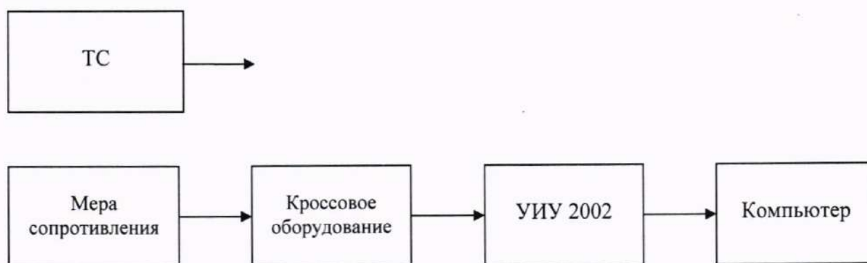
б) Схема определения метрологических характеристик поэлементным способом
