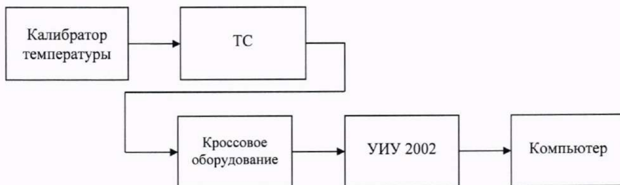
а) Схема определения метрологических характеристик комплектным способом
