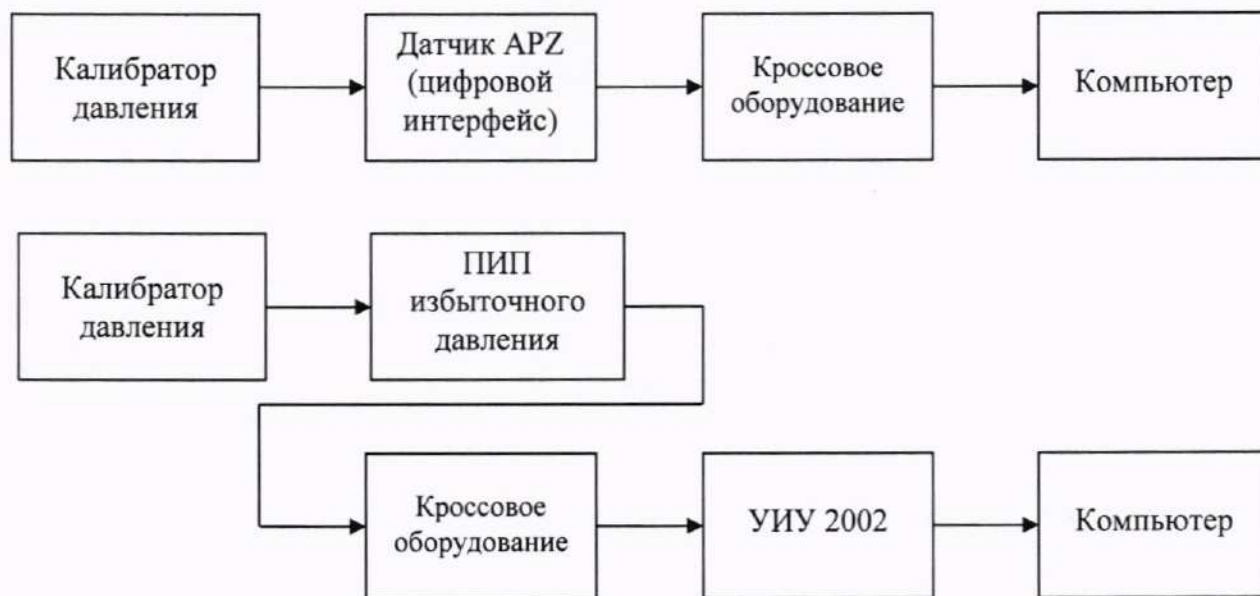
а) Схема определения метрологических характеристик комплектным способом
