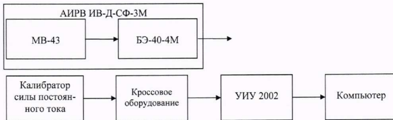
Рисунок 7 - Схема определения метрологических характеристик ИК виброскорости
