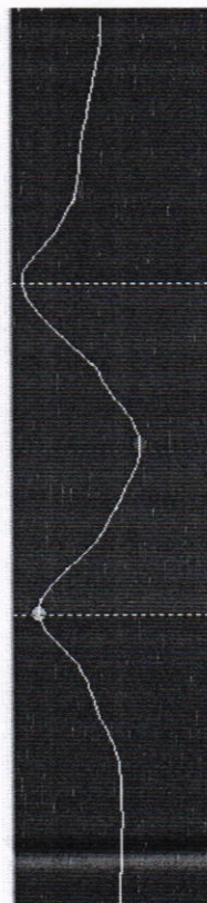
Рисунок 13 – Установка измерительного stroba для измерения протяженности между индикациями несплошностей
