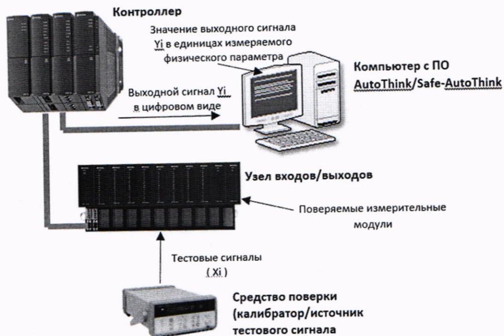
Рисунок 1 – Схема поверки модулей измерительных систем управления LK(S)
