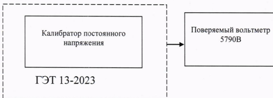
Рисунок 3 - Схема соединения приборов при определении основной погрешности вольтметра в режиме измерений постоянного электрического напряжения
