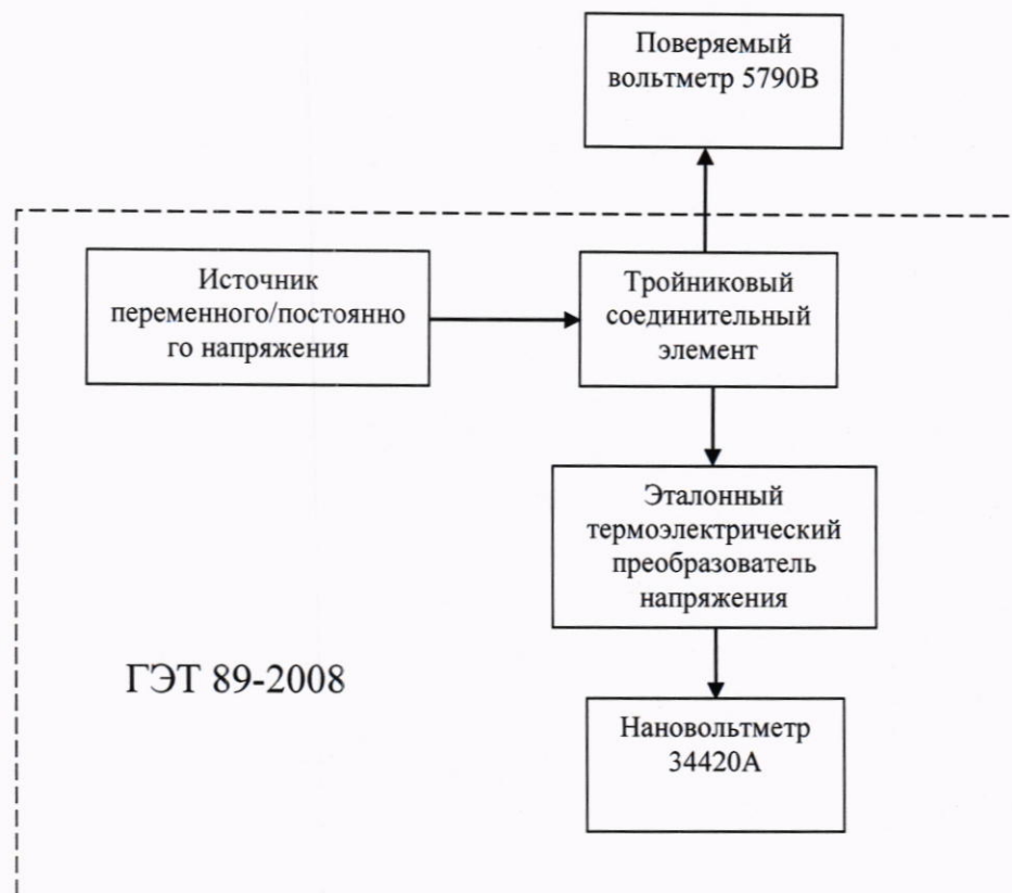
Рисунок 2 - Схема соединения приборов при определении основной погрешности вольтметра в режиме измерений переменного электрического напряжения.
