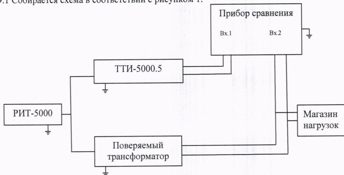
Рисунок 1 – Схема определения токовых и угловых погрешностей трансформаторов
