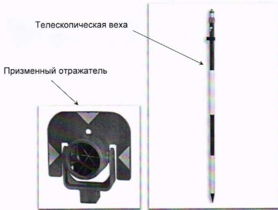
Рисунок А.1 – Веха телескопическая с призмным отражателем
